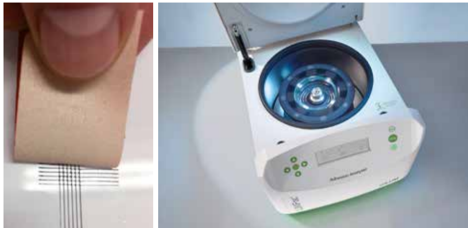
Mit dem Gitterschnitt-Test (links) und dem Gerät LumiFrac lässt sich die Haftwirkung schnell bestimmen.
