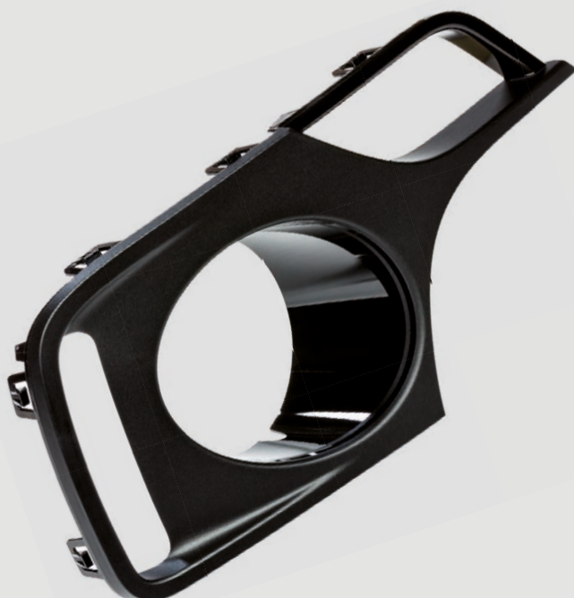
Gehäuse Nebelscheinwerfer – hochglänzende und matte Oberfläche in einem Teil
