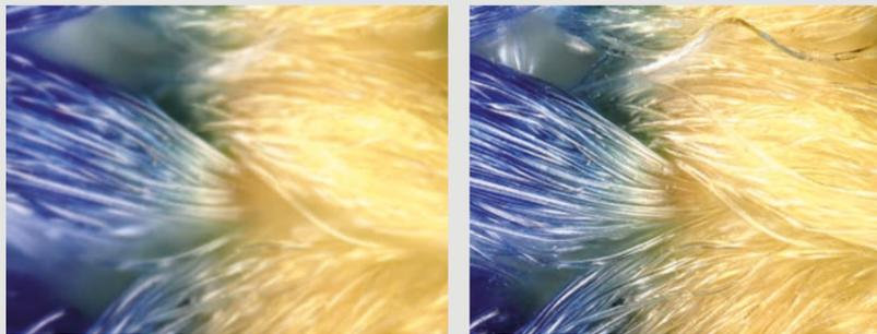
*Aufnahmen von Fasern in 500-facher Vergrößerung. Links: normale Aufnahme, rechts: tiefscharfes Bild.*
